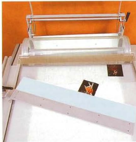
einer Scheibe, welche ebenfalls von der Bedienungsebene aus motorisch gedreht werden kann. So können Maßstab, Ausschnitt und Winkellage schnell, sicher und sehr bequem und viel genauer als bisher auf das Layout eingepaßt werden. Ein Tastendruck läßt den Projektionskopf wieder in die bequeme Ausgangs- oder Ladeposition zurückfahren, wo man die «Schublade» wieder öffnet.
