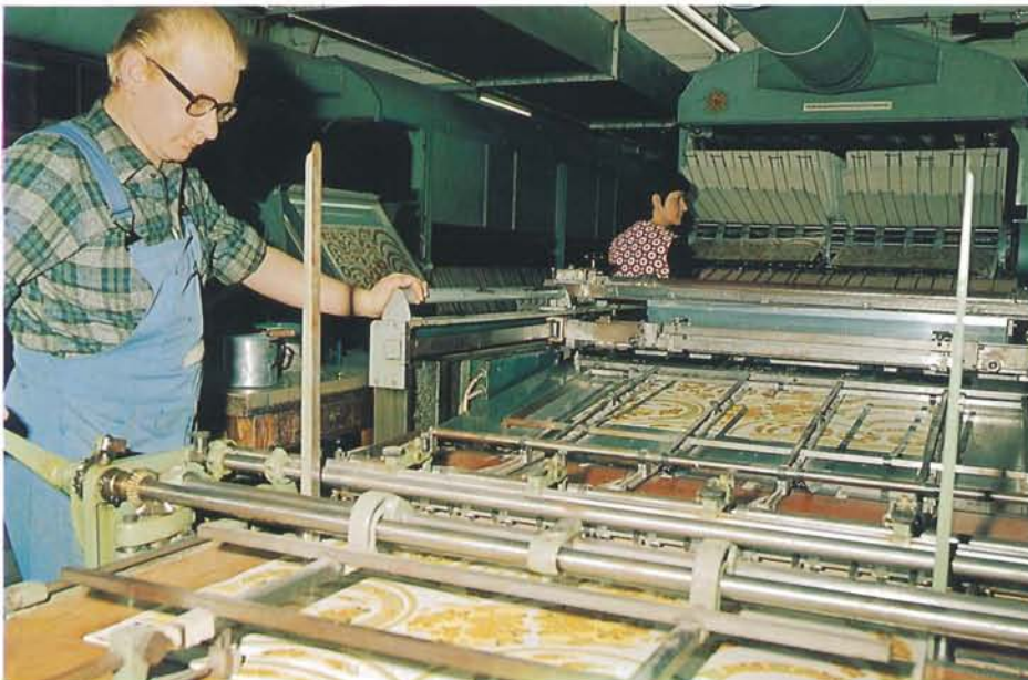
Bild 4. Arbeit an der Siebdruckmaschine mit fertigen Bogen von Abziehbildern.
