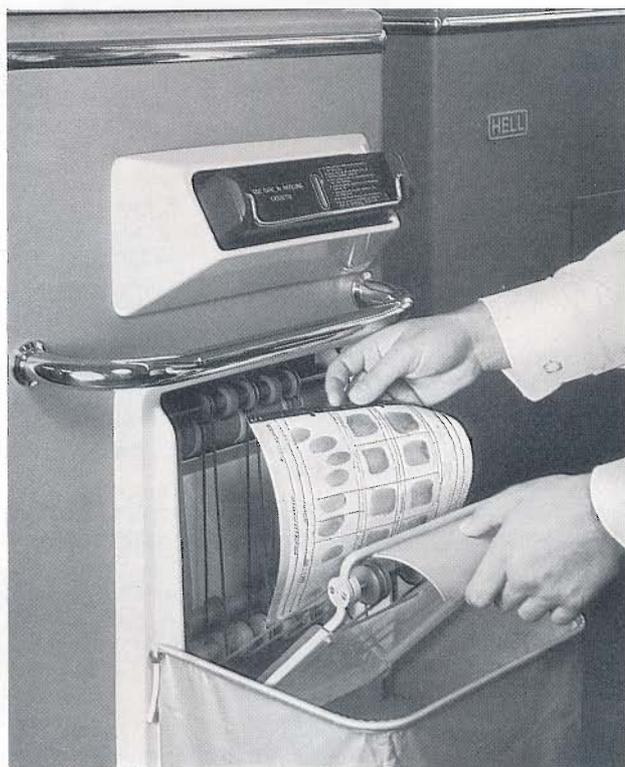
Bild 2. Ohne Zwischenprozesse kann das fertig entwickelte Fahndungsfoto dem Hell-Telebild-Empfangsautomaten TM 832 entnommen werden.
