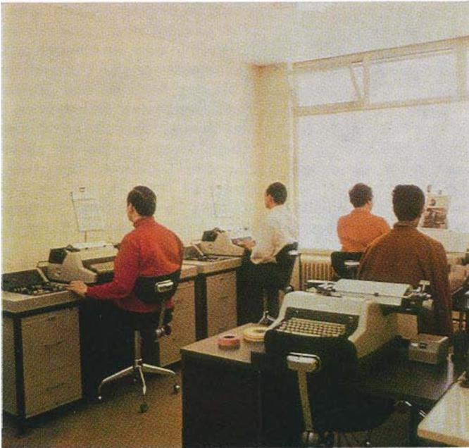
Im Tasterraum. Helltypen I dienen zur Niederschrift des Erstlochstreifens. Helltypen III, links im Bild, sind speziell dem rechnergesteuerten Satz und dem Lichtsatz angepaßte Texteingabegeräte.
