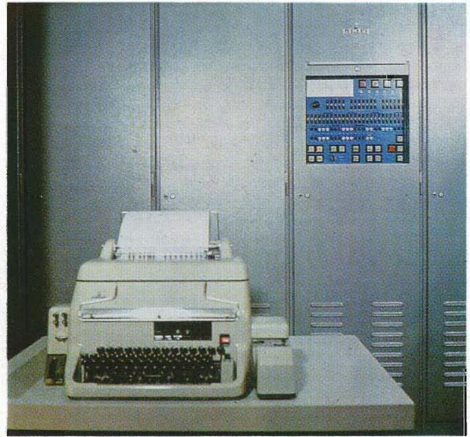
Der Satzrechner Hellcom, im Vordergrund der Bedienungsblattschreiber. Über den Bedienungsblattschreiber wird die Anlage vom Operator bedient.
