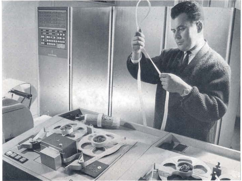
Bild 1. Die erste, als Satzrechner arbeitende Siemens Datenverarbeitungsanlage 3003 wurde in gemeinsamer Arbeit der Firmen Dr.-Ing. Rudolf Hell und Siemens entwickelt.
