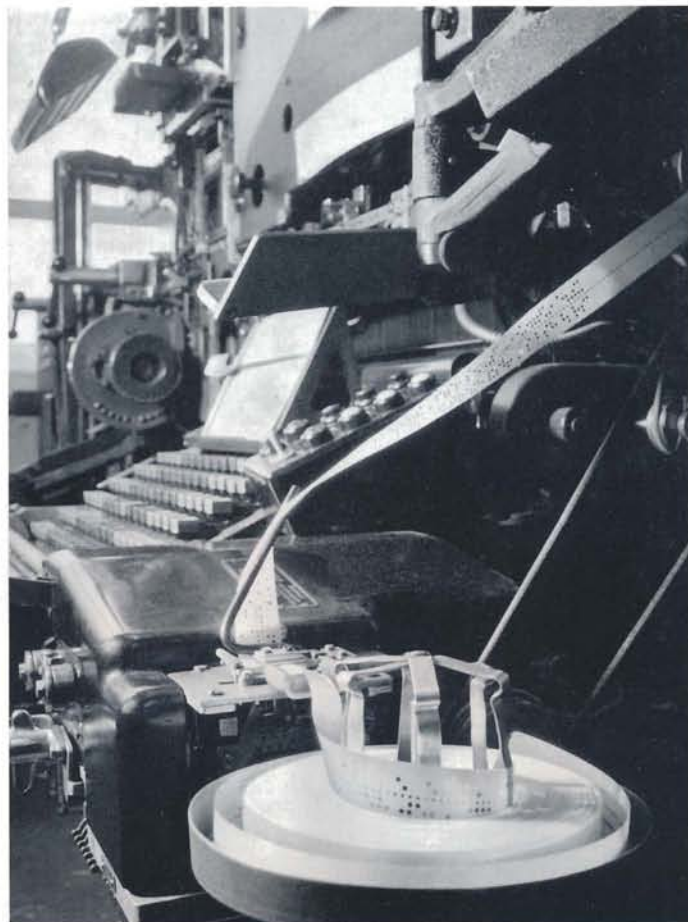
Bild 2. Die Endstation der automatischen Satzherstellung. Der vom „Erich“ ausgegebene Lochstreifen steuert eine TTS-Gießmaschine.
