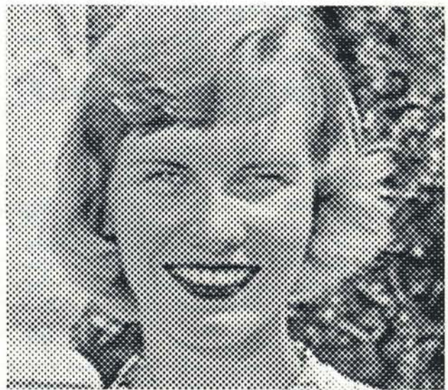
Bild 5: Gravur mit Tiefdruckraster
