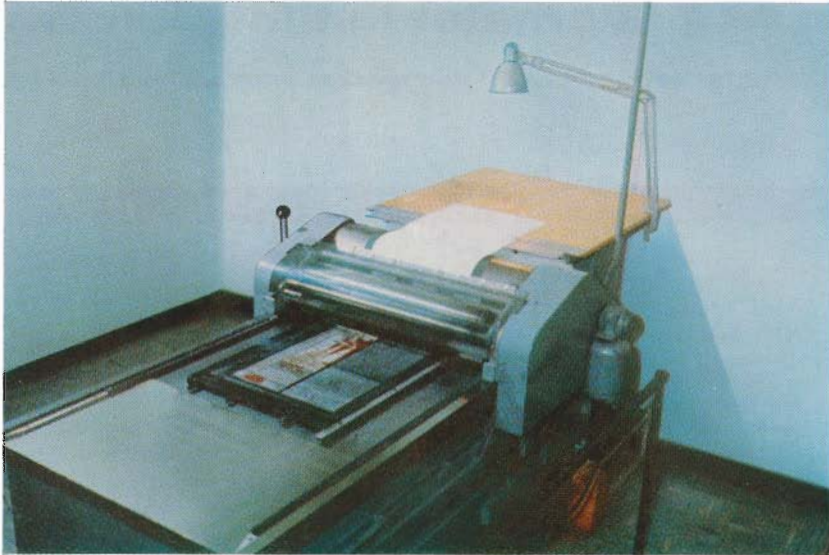
Auf dieser Andruckpresse werden die Seitenabzüge hergestellt, die für die Übertragung gebraucht werden.
