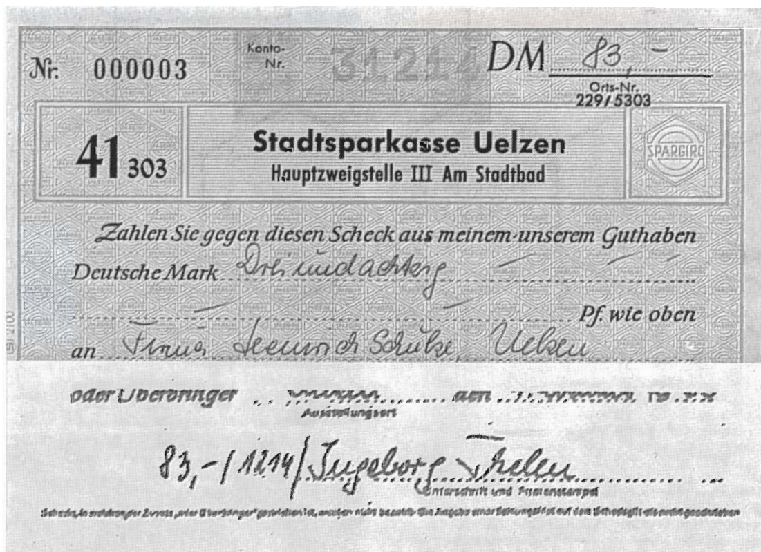
Ein Scheck der Stadtparkasse Uelzen und das Faksimile. Die Gegenüberstellung des Faksimiles mit dem Originalscheck beweist die außerordentliche Wiedergabetreue der ZETFAX-Übertragungen. Der grüne Schutzunterdruck der Scheckvordrucke wird elektronisch unterdrückt, so daß die Handschrift des Ausstellers unverfälscht und klar für die Prüfung zur Verfügung steht.
