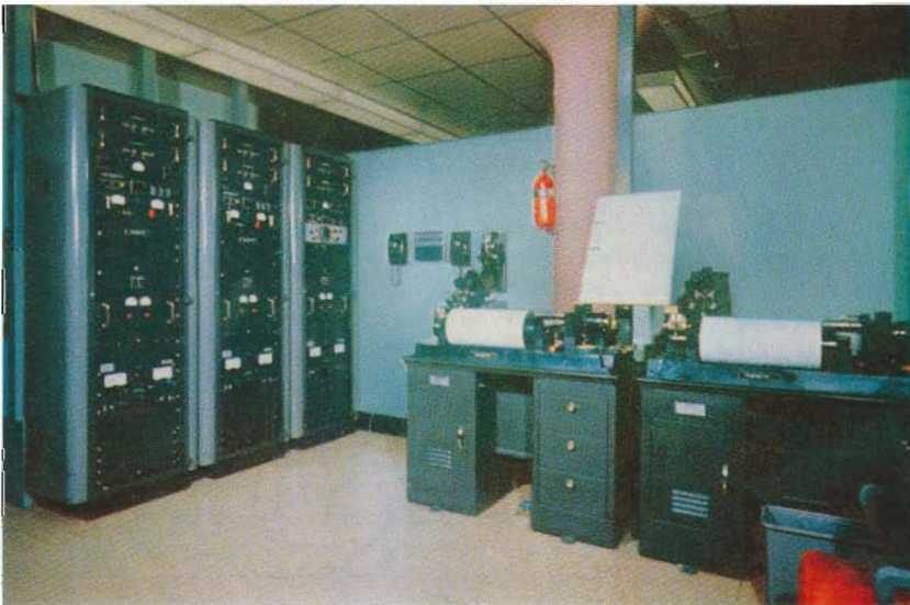
Faksimile-Übertragungsraum in San Franzisko mit zwei Sendern, auf deren Walzen zwei volle Seitenabzüge aufgespannt sind, und die zugehörige Elektronik.
