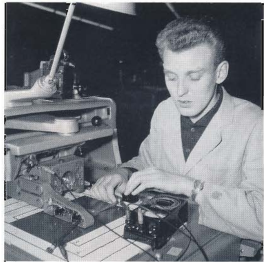
Hier wird die Justierung der Wendkontakte kontrolliert
