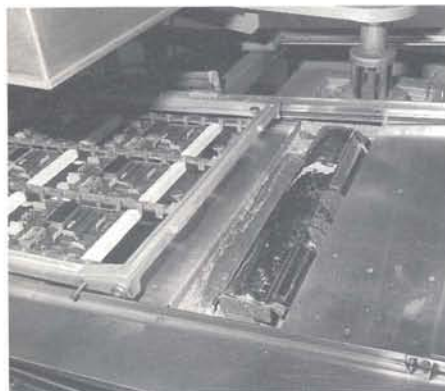
Die bestückten Leiterplatten werden in einem Zinn-Schwallbad gelötet. In einem Arbeitsgang werden alle elektrischen Verbindungen zwischen den Kontaktbeinen der Bauelemente und den Leiterbahnen hergestellt.
