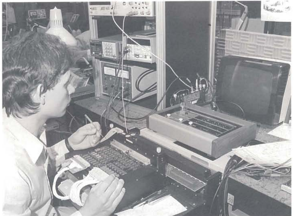
Leiterplatten — die Träger und Verbindung der elektronischen Bauelemente sind — werden bei Hell «per Hand», aber computergeführt, bestückt.
