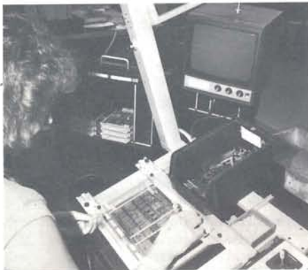
Leiterplatten — die Träger und Verbindung der elektronischen Bauelemente sind — werden bei Hell «per Hand», aber computergeführt, bestückt.
