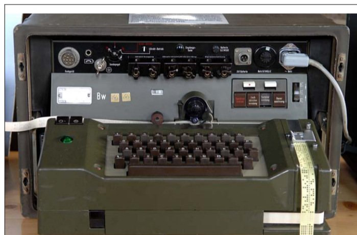
Der Hellschreiber (hier ein Modell für die Bundeswehr): Nachrichtagenturen übermittelten damit Meldungen. Fotos August/hfr
