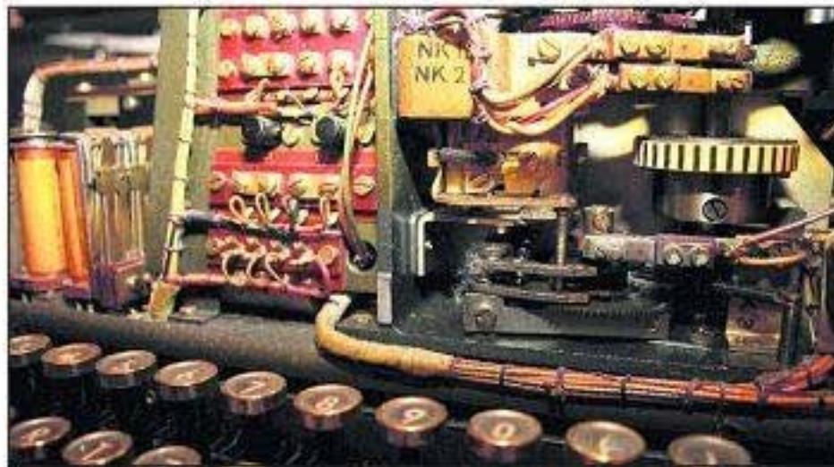
Ein Blick auf das Innere eines S-Hell-Schreibers von 1955, das S steht für die Firma Siemens.
