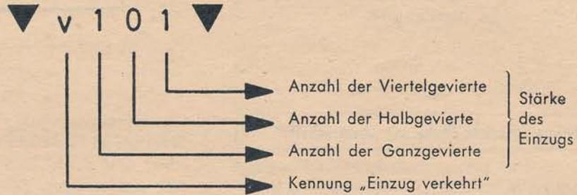
Die Anweisung bewirkt, daß jeweils nach dem Tasten-Anschlag „links ausschließen“, der einen Absatz (z. B. eine Klein-Anzeige) beendet, die folgende Zeile nicht, alle übrigen Zeilen jedoch um die angegebene Stärke eingezogen werden.
