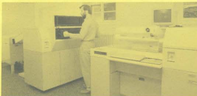
Der DC-3000 von Hell: Getrennte Einheiten, Abtastseite 3010 vom Tageslicht-Recorder. Online Verbindung von Recorder 3020 mit der Entwicklungsmaschine. Jonas Bosshard wechselt gerade eine 60-m-Filmrolle.
