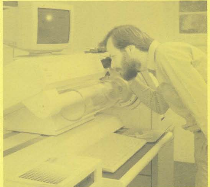
Gut sichtbar beim neuen Hell DC-3000: der einseitig gelagerte Zylinder, dank dessen Diaarm und Optik nicht mehr gewechselt werden müssen.
