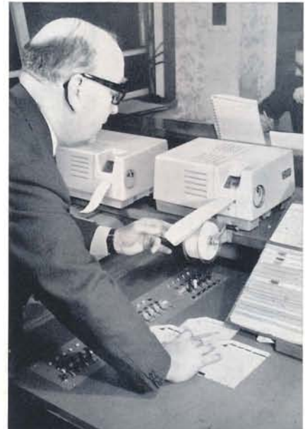
Automatische Vermittlung Typ VE 237—38.1 für den Anschluß von max. 5 Gebern und 2 Schreibern
