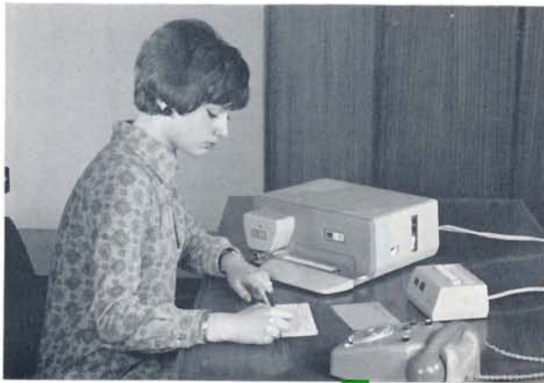
ZETFAX-Geber Typ HT 206 mit Linienwähler zu 5 Anschlüssen Typ VE 237-670 mit zusätzlicher Besetztzeichengabe und Anrufspeicherung
