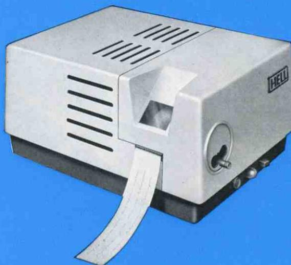
Der ZETFAX-Geber ist mit einem oder mehreren ZETFAX-Schreibern durch Telefonleitungen direkt oder über Teilnehmerwähler verbunden. Drahtlose Übertragung, amplituden- oder frequenzmoduliert, kann mit entsprechenden Sende- und Empfangsgeräten erfolgen.
