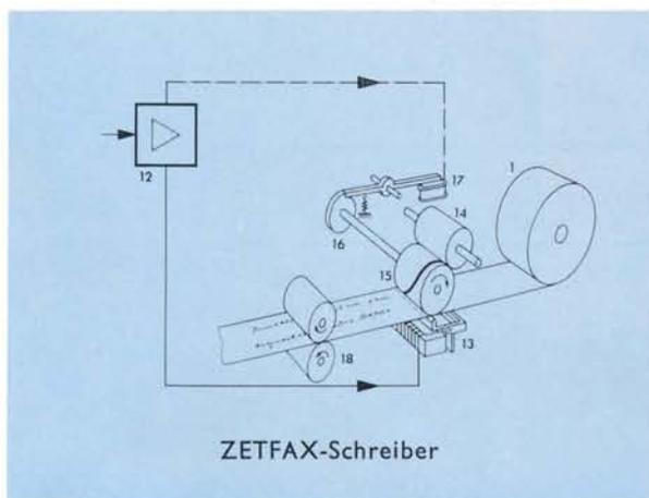
Der **ZETFAX-Geber** ist mit einem oder mehreren ZETFAX-Schreibern durch Zweidrahtleitungen direkt oder über Teilnehmerwähler verbunden. Drahtlose Übermittlung, amplituden- oder frequenzmoduliert, ist möglich.
