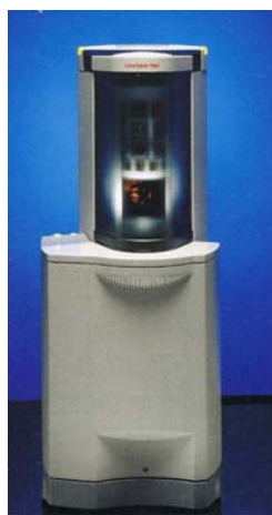
Reproduktionstechnik für die Druckvorstufe: Trommelscanner Tango (Primescan) aus dem Jahre 1997
